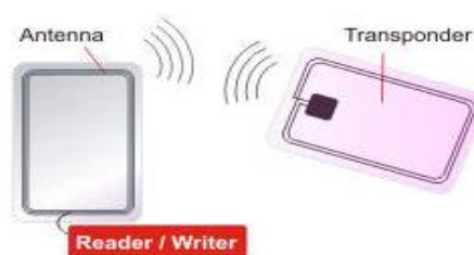
Gambar 1 Cara Kerja RFID
